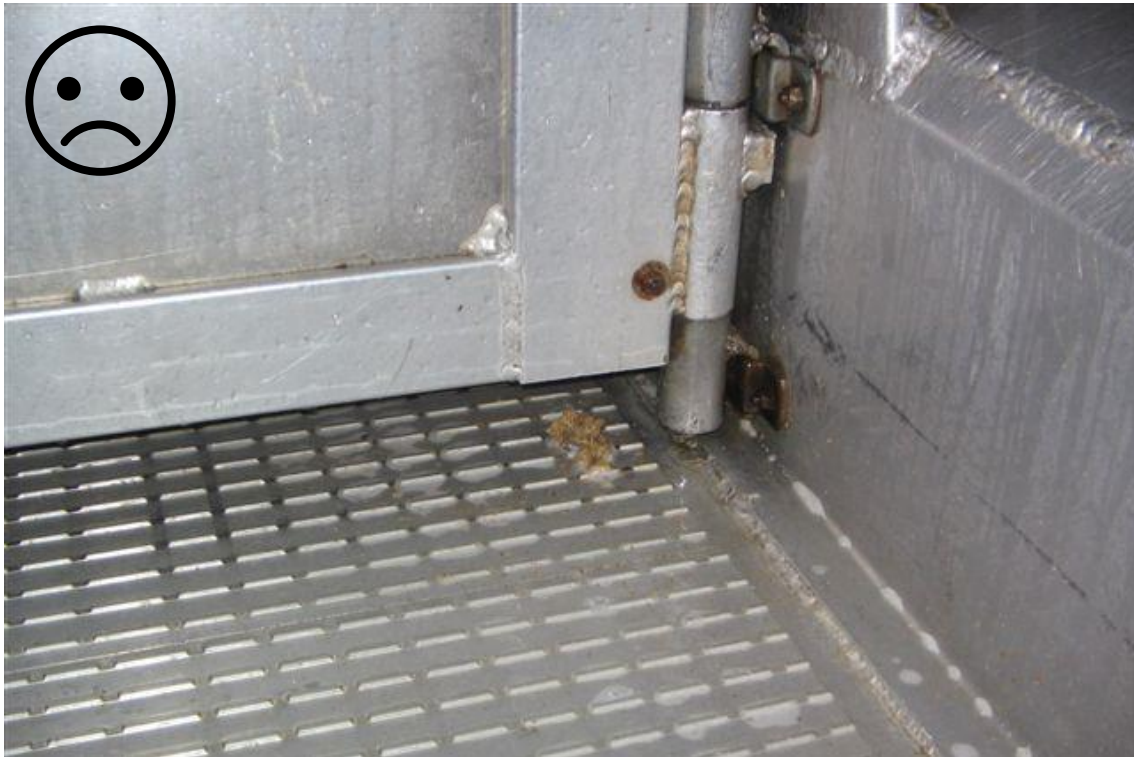
Figur 18. Tydeligt spor af gødning – AFVIST / Clear traces of manure – REJECTED.
