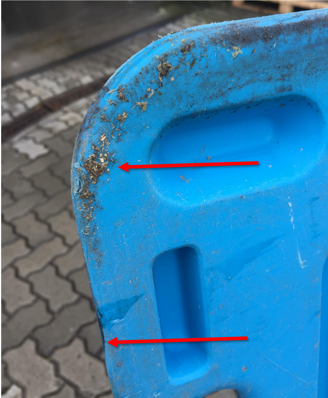
Figur 7. Drivbræt med skidt på og revner i skal kasseres (iflg. DANISH Transportstandard). Pushing plate with dirt or cracks must be scrapped (according to DANISH Transport Standard).
