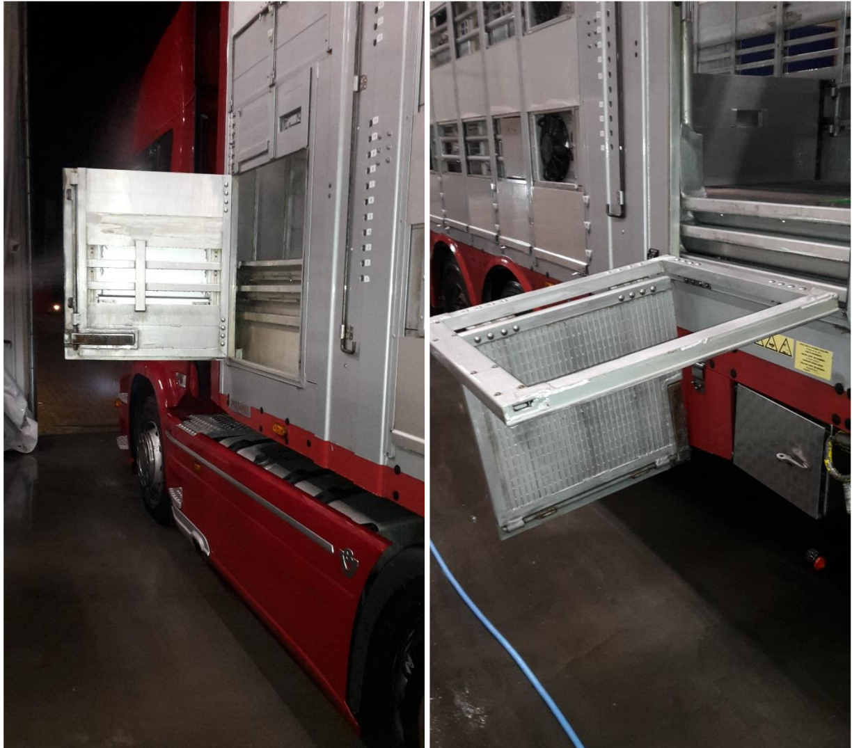
Figur 20. Låger med dobbelt-åbning hvor skidt kan gemme sig / Doors with double-opening where dirt can hide.
