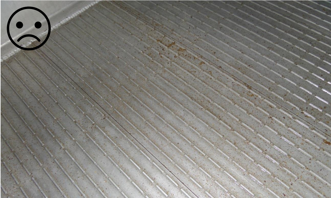
Figur 14. "Nister"/stænk af skidt – AFVIST / "Flecks"/splash of dirt – REJECTED.
